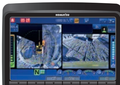
Avec KomVision, les différentes caméras vous offrent une vue aérienne constante de la machine
