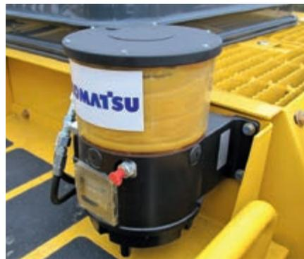
Automatische Zentralschmieranlage (Option)
