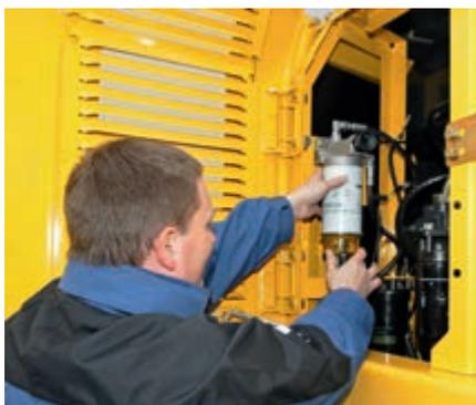
Sistema per la manutenzione centralizzata
