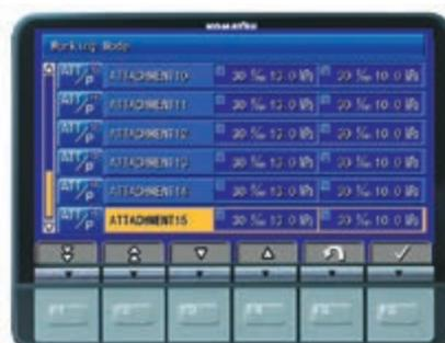
Komatsu Integrierte Anbaugerätsteuerung (KIAC)
