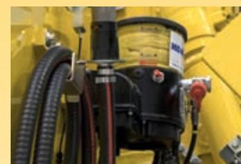
Automatische Zentralschmieranlage (Option)
