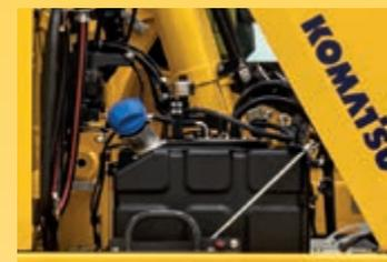
Einfacher Zugang zum AdBlue®-Tank
