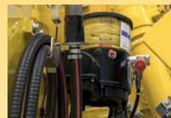
Graissage centralisé automatique (en option)
