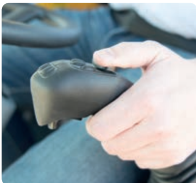
Ergonomiska joysticks med proportionella kontroller
