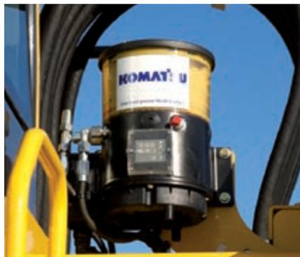
Automatische Zentralschmieranlage (Option)
