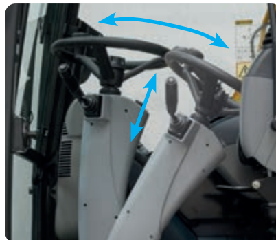
Die serienmäßige, weit verstellbare Lenksäule lässt sich für jeden Fahrer individuell anpassen
