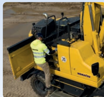
Handrails en antislipplaten voor een handige en veilige toegang tot de onderhoudspunten
