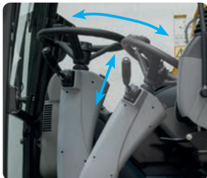
Het standaard telescopische stuurwiel kan eenvoudig aan de lengte en reikwijdte van de machinist worden aangepast.
