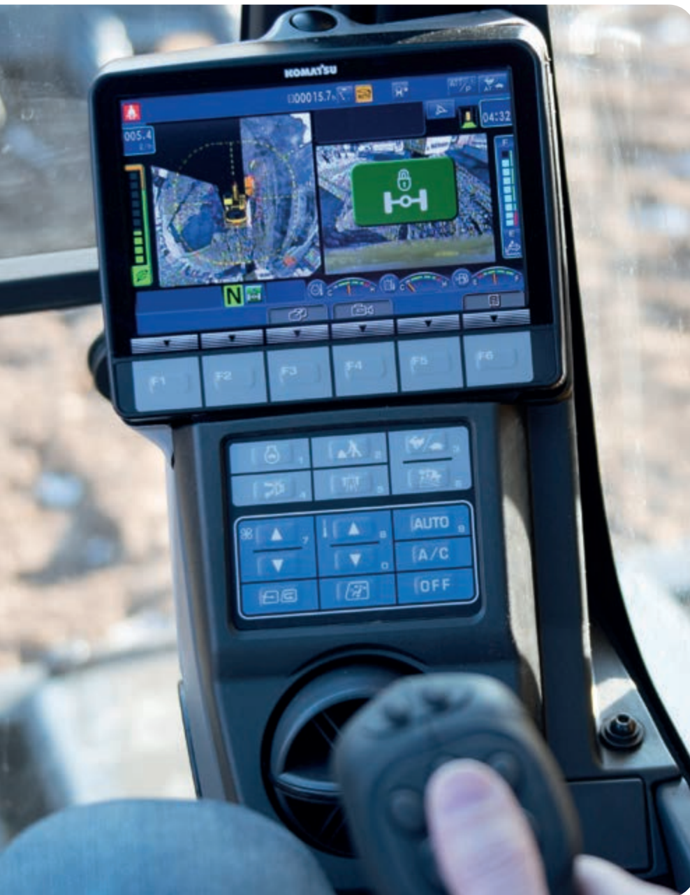
Mit Universalverrohrung für Anbaugeräte wie Hydraulikhämmer ausgerüstet. Für den Wechsel zu geringerem Druck muss lediglich die Taste für die Hammer-Betriebsart am Monitorsystem gedrückt werden.
