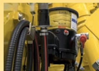
Graissage centralisé automatique (en option)
