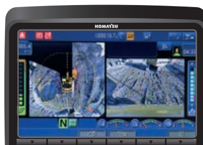
Med KomVision hjälper olika kameravyer till att upprätthålla ett konstant fågelperspektiv ovanifrån maskinen
