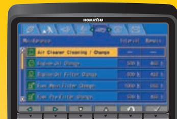
Der Wartungsbildschirm des Monitorsystems zeigt die Austauschintervalle und die verbleibende Zeit bis zum Austausch für Öl und Filter an
