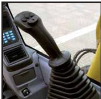
Joystick mit Proportionalsteuerung für Anbaugeräte
