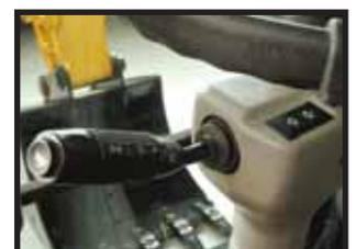
Volant inclinable avec plusieurs fonctions; commande essuie-glace, indicateur, klaxon, phare avant
