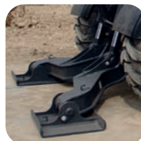
Cilindros hoja/estabilizador con válvula de comprobación integrada (de serie)
