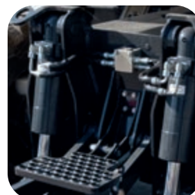
Cilindros hoja/estabilizador con válvula de comprobación integrada (de serie)
