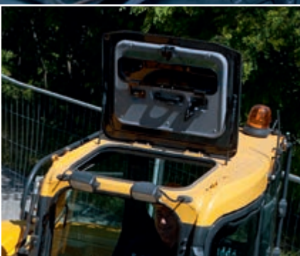
Aufklappbare Dachluke für optimale Sicht nach oben
