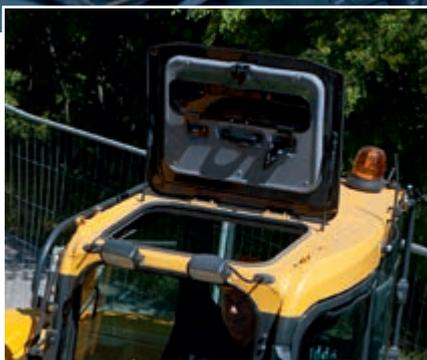
Toit ouvrant pour la visibilité au-dessus de la cabine
