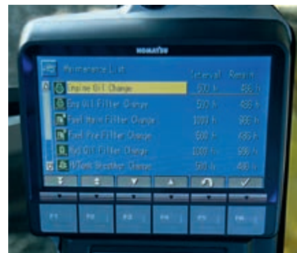
Il monitor a cristalli liquidi indica le anomalie e gli intervalli di sostituzione
