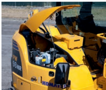
I più importanti punti di manutenzione possono facilmente essere raggiunti da terra
