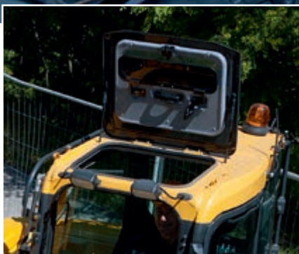
Il tettuccio apribile assicura la visibilità verso l'alto
