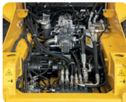
La cabine inclinable peut être soulevée en quelques minutes pour ouvrir l'accès au distributeur et aux principaux composants hydrauliques
