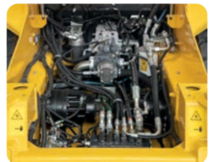
La cabina tiltabile può essere sollevata in pochi minuti, garantendo un facile accesso alla valvola principale e ai componenti idraulici più importanti
