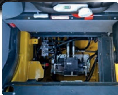
Dank der in die Kabine integrierten Motorhaube können zusätzliche Wartungsarbeiten am Hauptsteuerblock in kürzester Zeit durchgeführt werden, ohne dass die Kabine gekippt werden muss.
