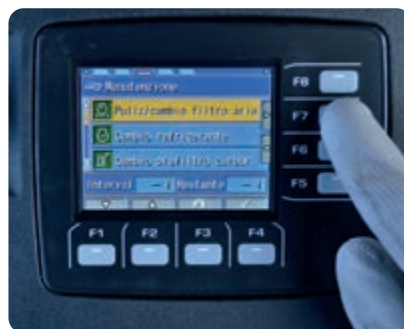
Schermata della manutenzione di base sul monitor a colori da 3,5"
