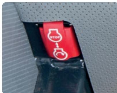
Interrupteur d'arrêt secondaire du moteur
