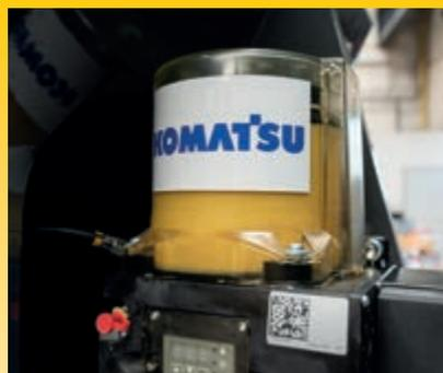
Le graissage centralisé automatique intégré d'usine réduit l'entretien quotidien au strict minimum (en option)
