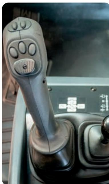
Levier multifonctions PPC avec contrôle de pilotage électronique (EPC, en option) pour la 3ème et la 4ème fonction hydraulique
