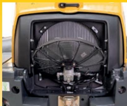
Ventilateur de refroidissement inclinable pour un accès aisé pour le nettoyage
