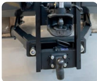
Crochet type « boule » et crochet automatique
