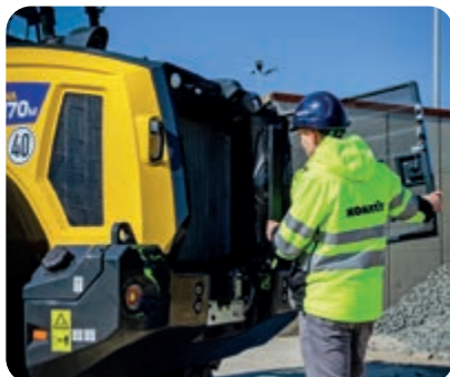
Grobmaschiger Kühler mit schwenkbarem Kühlerlüfter
