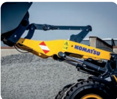
„Tool linkage“-Hubgerüst oder Z-Kinematik (optional)
