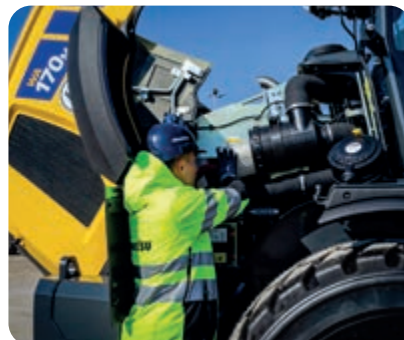
Zugang zu täglichen Wartungspunkten vom Boden aus
