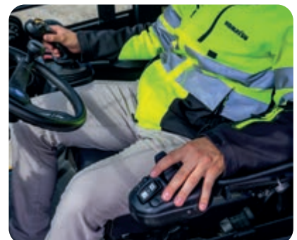
Die integrierte rechte Konsole bewegt sich mit dem Fahrersitz und sorgt für herausragenden Fahrerkomfort
