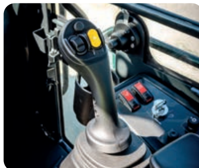
PPC-Multifunktionshebel mit elektronischer Steuerung der 3. Hydraulikfunktion
