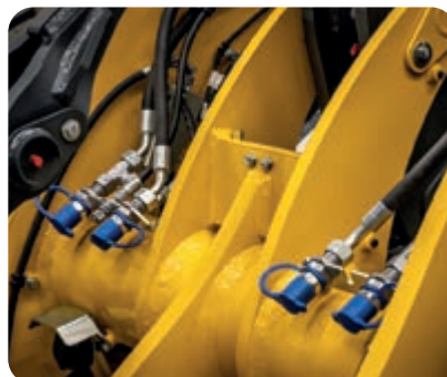
3de hydraulische functie met hoge doorstroming (160 l/min bij 220 bar)
