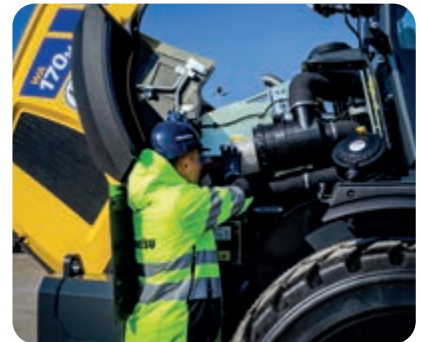
Dagelijkse onderhoudspunten bereikbaar vanaf de grond
