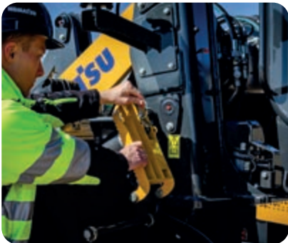
Trede vooraan om de voorruit schoon te maken
