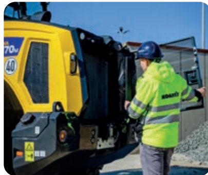
Grofmazige radiator met naar buiten wegklapbare ventilator
