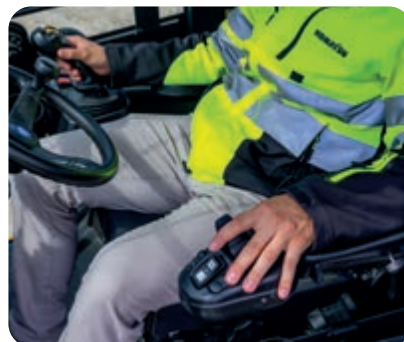
Integrerad konsoll på höger sida rör sig tillsammans med förarsätet för enastående förarkomfort
