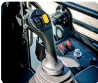
PPC-flerfunktionsspak med elektronisk styrning för 3:e extra hydraulikrets
