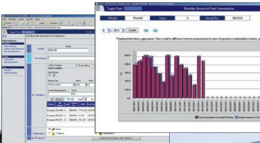
Ein einfach lesbares Diagramm stellt den Kraftstoffverbrauch der Maschine dar und unterstützt Sie bei der Berechnung von Kraftstoffkosten und Planung von Betankungsfahrten.
