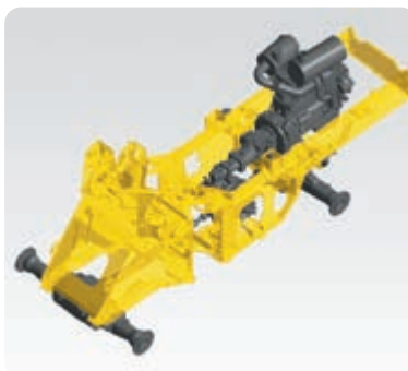
Robuust torsiebestendig frame
