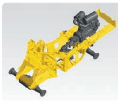
Châssis robuste et résistant à la torsion
