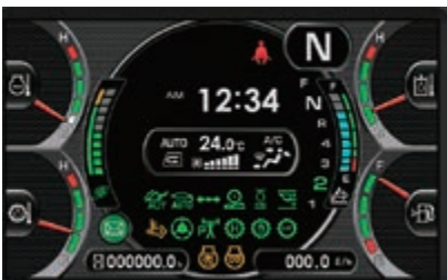
Lättöverskådlig information: LCD-skärm med basinstrumentpanel
