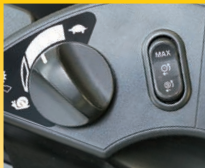
Variabel växlingskontrollskiva med nytt kryppområde för Hastighets (vänster) och variabel antislip Systemomkopplare (höger)
