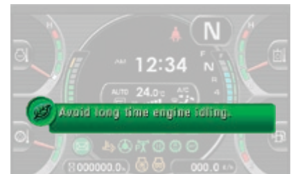
Eco-styrning underlättar energibesparingar i realtid (t. ex. genom att undvika långa tomgångskörningar)
