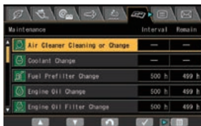
En multifunktionsmonitor visar och kontrollerar en mängd drift- och underhållsinformation
