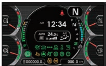
Lättöverskådlig information: LCD-skärm med basinstrumentpanel
