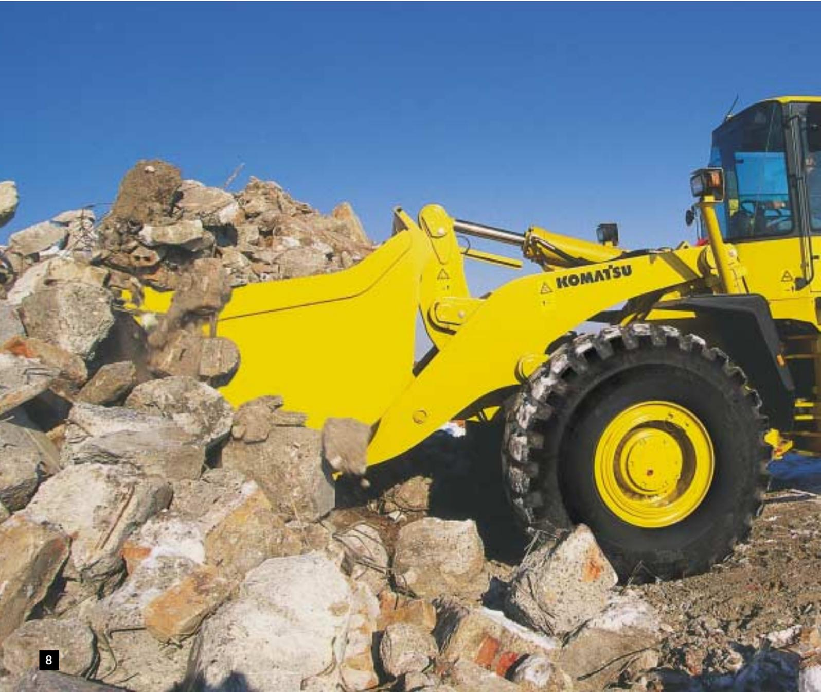
naben und sind auf höchste Belastbarkeit ausgelegt. Sie sind absolut nachstellfrei. Durch die geschlossene Bauweise im Ölbad ist höchste Betriebssicherheit bei extrem langer Lebensdauer sichergestellt. Die vollhydraulische Bremse bietet ein Höchstmaß an Servicefreundlichkeit. Durch die Untersetzung in den Radnaben – also genau dort, wo das höchste Moment verlangt wird – werden vorgelagerte Elemente wie Steckachsen und
