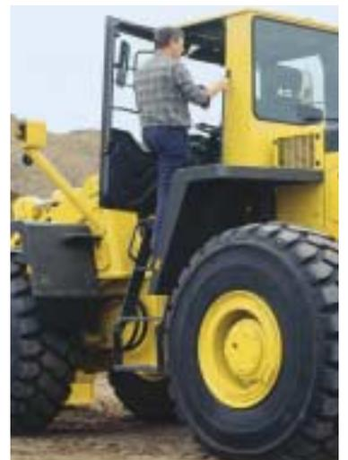
*Ergonomischer Aufstieg und eine geräumige Kabine erhöhen den Fahrkomfort.*
