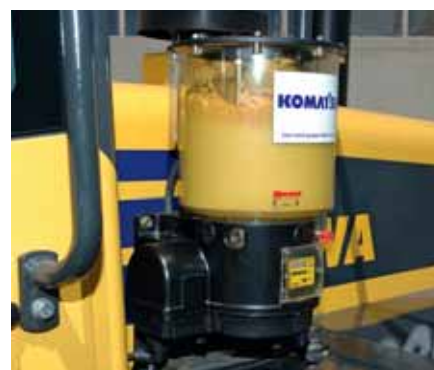
Impianto di lubrificazione automatica
