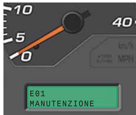
Sistema di monitoraggio e diagnostico EMMS
