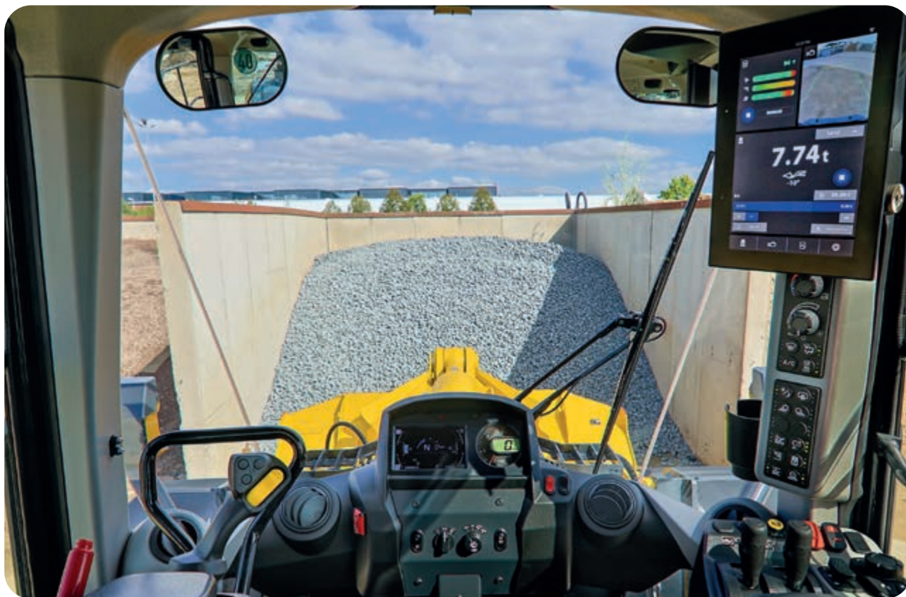
De afbeelding toont de geavanceerde joystickbesturing (AJSS) (optie) en SubMonitor (optie)
