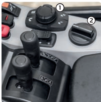
Nydesignade kontroller. Kommandoväljaren (1) möjliggör bekväm navigering genom monitormenyerna, som i en personbil. Den nya ratten för kontroll av körhastigheten (2) håller maskinens hastighet konstant vid färd i nedförsbacke.
