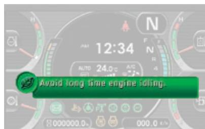
Eco-Hinweise ermöglichen Energieeinsparungen in Echtzeit (z.B. lange Motorleerlaufphasen verhindern)
