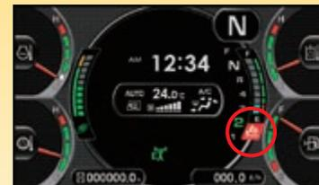
Jauge du niveau de liquide AdBlue® et assistance au remplissage
