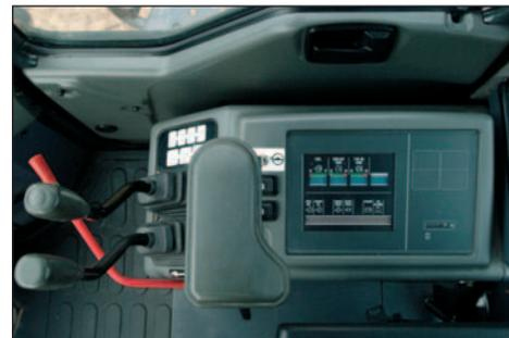
Il pannello di controllo per la manutenzione mostra le condizioni dei principali componenti di funzionamento.
