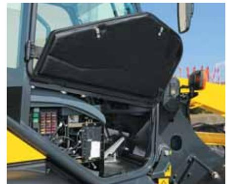
*Seitliche Wartungsklappe für schnellen Wartungszugang*
