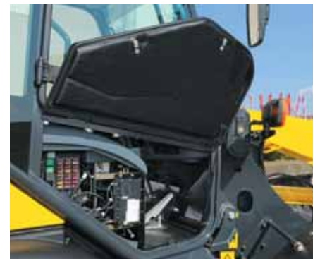
Seitliche Wartungsklappe für schnellen Wartungszugang
