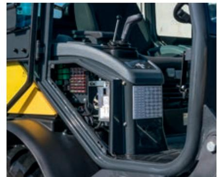
*Seitliche Wartungsklappe für schnellen Wartungszugang*
