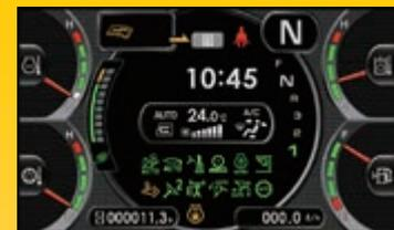
Das Multifunktionsmonitorsystem zeigt jede Abweichung von den normalen Werten ebenso wie Öl- und Filterwechselintervalle rechtzeitig an. Fehlersuche und Wartung werden durch die direkte Abrufmöglichkeit der Daten entscheidend vereinfacht.
