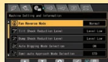
Reinigungsfunktion des Kühlerlüfters
