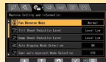
Nettoyage du ventilateur du radiateur en mode de rotation inversée
