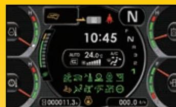
Il monitor multifunzione fornisce all'operatore informazioni sulla manutenzione e il funzionamento della macchina, segnalando, per esempio, la necessità di sostituzione dei filtri dell'olio o eventuali anomalie. Inoltre, fornisce ai meccanici Komatsu informazioni dettagliate, eliminando l'utilizzo di strumenti di assistenza esterni.
