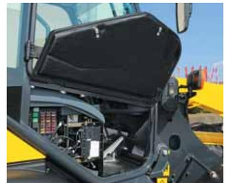
*Seitliche Wartungsklappe für schnellen Wartungszugang*
