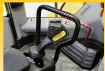
Modernes Joystick-Lenksystem mit neuem Design
