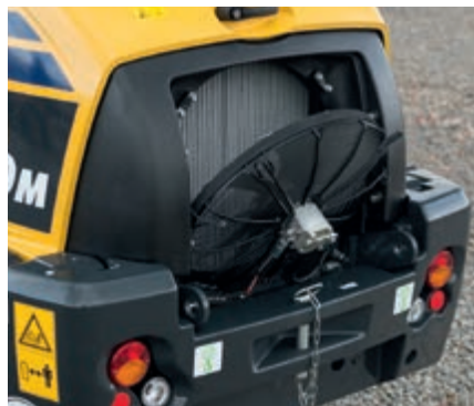
Kippbarer Kühlerlüfter für bequeme Reinigung
