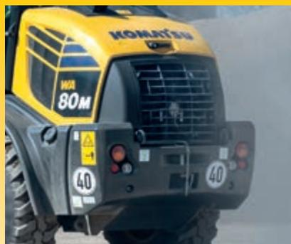
Radiateur à grandes alvéoles avec ventilateur à inversion automatique (en option)
